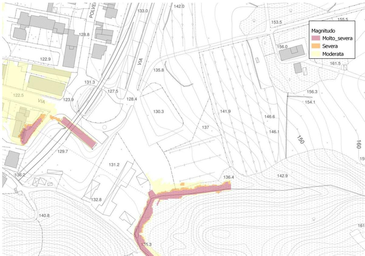
*Configurazione della "magnitudo idraulica" desunta dagli studi di modellazione idraulica (tav. STR.I04a del PS)*
