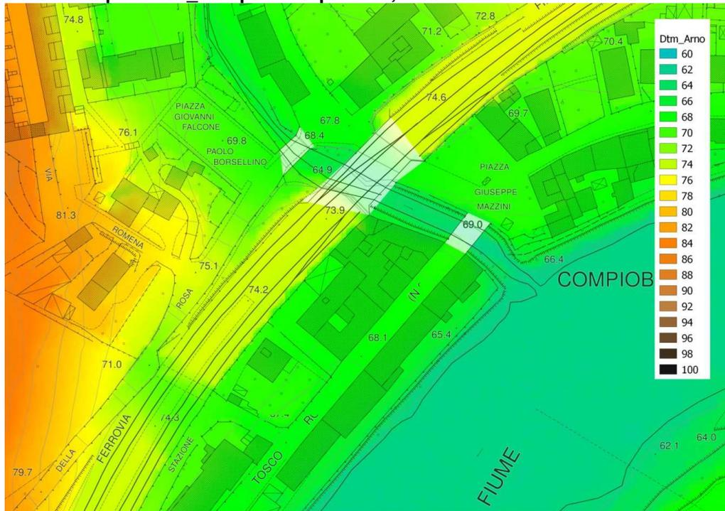
*Estratto planimetrico modello del terreno con indicazione dei punti quotati che individuano per l'area in esame quota lidar 68,10 m.s.l.m.*
